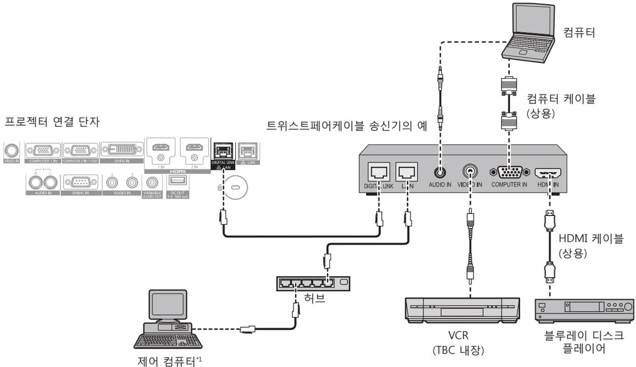
\*1 제어 타겟은 프로젝터 또는 트위스트 페어 케이블 송신기로 됩니다. 트위스트 페어 케이블 송신기에 따라서는 제어 자체를 할 수 없는 경우가 있습니다. 접속할 장치의 사용설명서를 확인해 주십시오.
